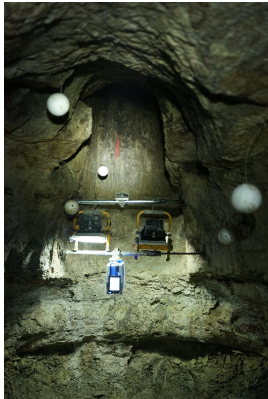
Abb. 2: Hängende Stationierung des Scanners mit Beleuchtung und Verknüpfungspunkten (Foto: Yvo Weidmann, Geoldee)
