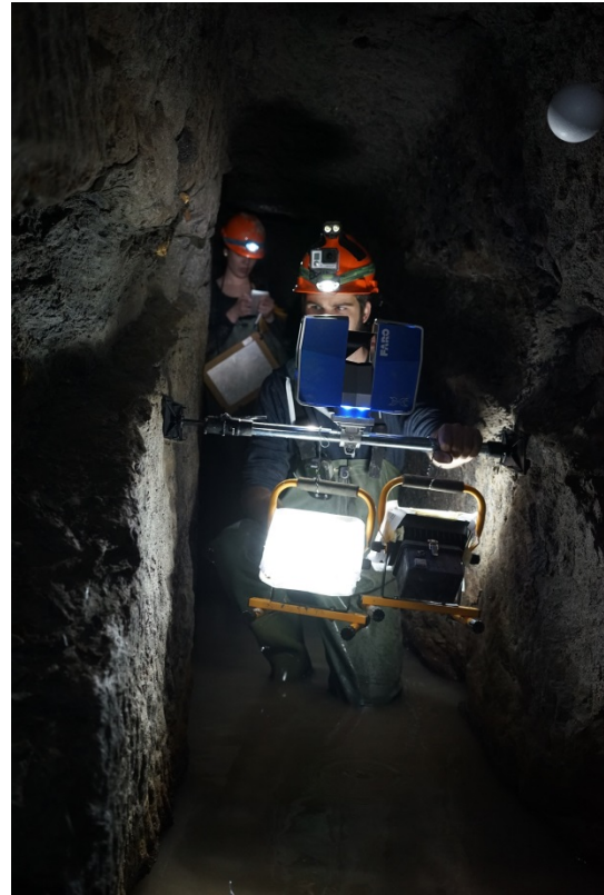
Abb. 3: Spannstativ mit aufgesetztem Scanner und Akkuscheinwerfer sowie mit Styroporkugeln signalisierte Verknüpfungspunkte (Foto: Yvo Weidmann, Geoldee)
